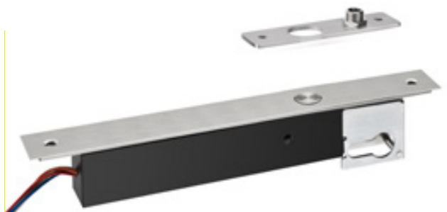
IN.28.503 Fechaduras eléctrica "DROP PIN" para cilindro europeu. Função aberto, só fecha com corrente eléctrica. A porta fica aberta com falha de corrente / Electric drop pin lock for european cylinder. Open function, only lock with electric power. The door stays open when there is no power / Cerradura eléctrica "DROP PIN" para cilindro europeu. Funcion abierto, solo cierra con energia electrica. La puerta se queda abierta con corte de energia.
